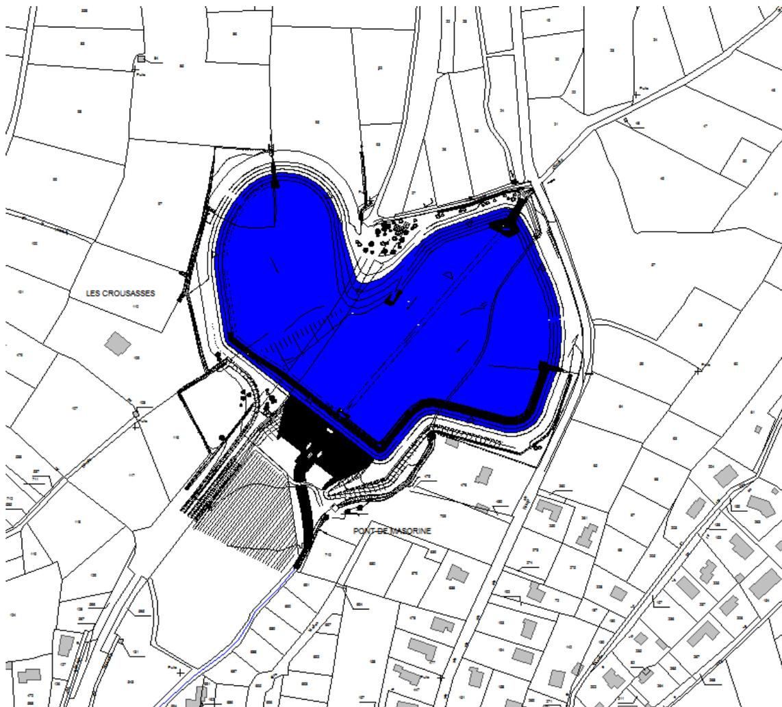
**Vue en plan et plan d'eau au niveau des Plus Hautes Eaux**
